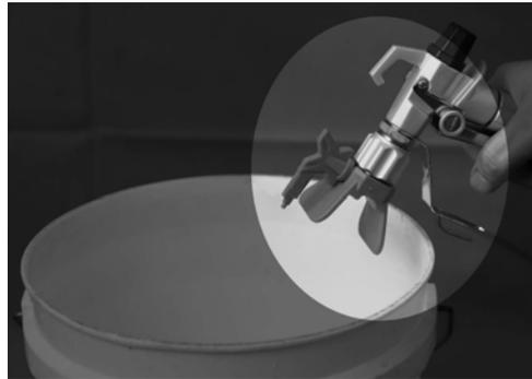
3. Halten Sie die Pistole fest an der Seite des Eimers. Betätigen Sie den Abzug, um den Druck abzubauen.
