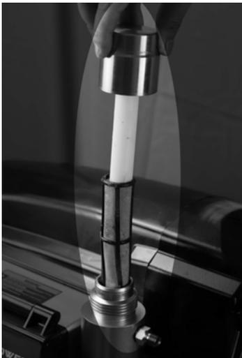
**9.** Entfernen Sie die Filter aus der Pistole und dem Sprühgerät, falls installiert. Reinigen und überprüfen Sie die Filter und setzen Sie sie anschließend wieder ein.
