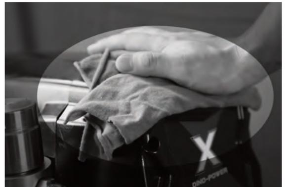
**12.** Wischen Sie das Sprühgerät, den Schlauch und die Pistole mit einem in Wasser oder Terpentin getränkten Lappen ab.
