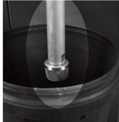
**11.** Wenn die Maschine länger als 10 Tage gelagert wird, nehmen Sie nach gründlicher Reinigung das Saugrohr, den Schlauch und die Pistole ab und gießen Sie etwa 10 ml weißes Schmieröl in die Flüssigkeitspumpe. Schalten Sie die Maschine ein und lassen Sie sie für 5 Sekunden im PRIME-Modus laufen (bis das Öl im Prime-Rohr sichtbar ist). Dies verhindert, dass die feuchten Teile im Inneren festkleben, korrodieren oder rosten
