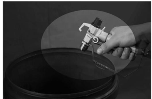
4. Bewegen Sie die Pistole zum Abfallbehälter, halten Sie die Pistole gegen den Behälter, betätigen Sie den Abzug, um das System gründlich zu spülen, lassen Sie den Abzug los und aktivieren Sie die Abzugssicherung.
