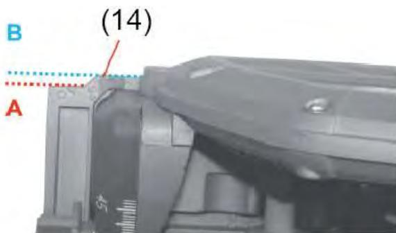
2. Für 45°-Gehrungsschnitte richten Sie die Position B (45-Markierung auf der Grundplatte) an der Vorderseite der Grundplatte auf ihrer gezeichneten Schnittlinie aus.
